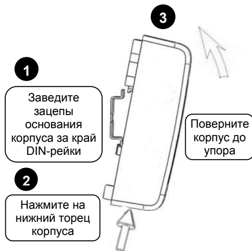
Рисунок 3. Крепление контроллера на DIN-рейку
