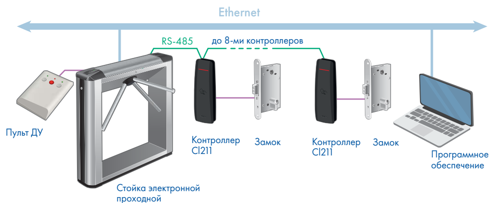
Структурная схема подключения электронной проходной
