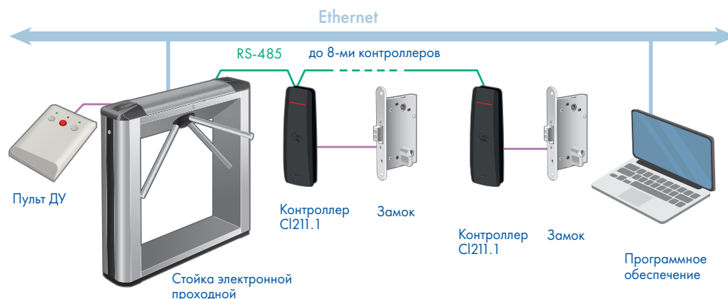
Структурная схема подключения электронной проходной
