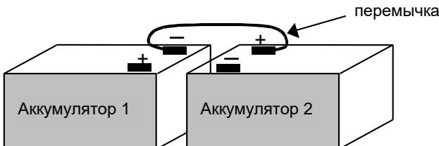
Рисунок 2 – схема последовательного соединения двух аккумуляторов
